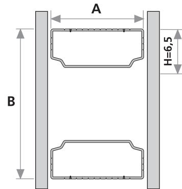
Cette gamme d'accessoires **1** et **2** permet la réalisation de vitrages Twin en utilisant les intercalaires pour vitrage isolant standard avec les différentes mesures et couleurs.
